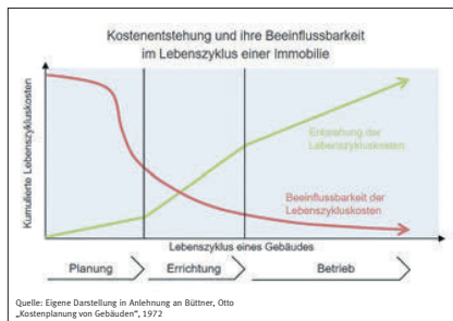
Abbildung: Kostenentstehung und ihre Beeinflussbarkeit im Lebenszyklus einer Immobilie Grafik: BS/Rechnungshof Hessen
